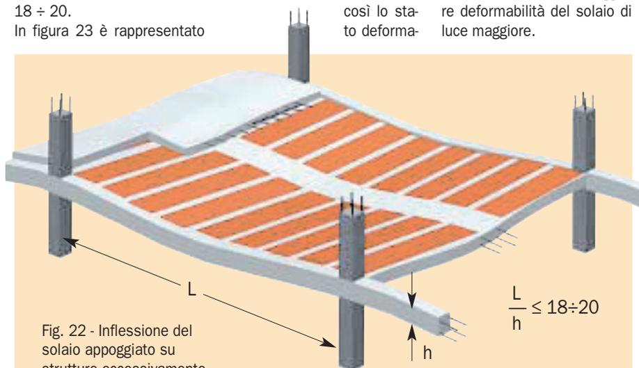
Fig. 22 - Inflessione del solaio appoggiato su strutture eccessivamente deformabili.
