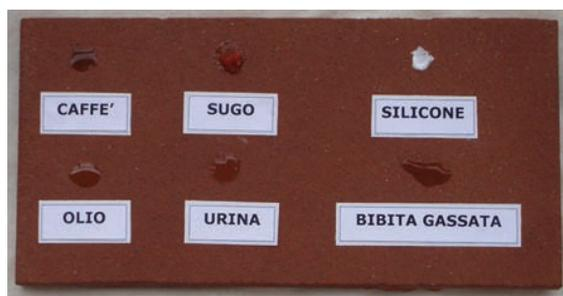
*Prova di macchiabilità su una pianella di cotto estrusa trattata con due passaggi di una soluzione di olio di lino crudo e acqua ragia al 50%. In alto, al momento dell'inizio della prova; in basso, dopo circa tre ore di permanenza dell'agente macchiante. Come può notarsi, al termine della prova la superficie appare del tutto priva di macchie e di aloni.*
