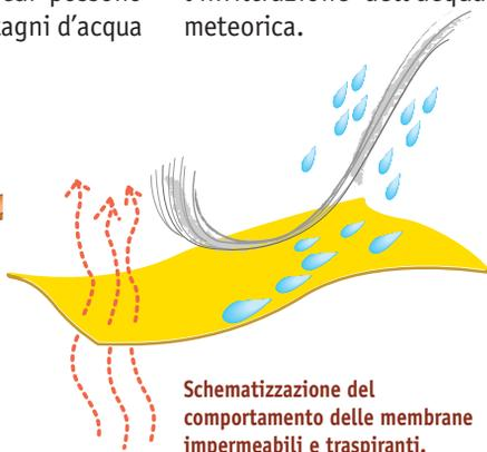
Schematizzazione del comportamento delle membrane impermeabili e traspiranti.
