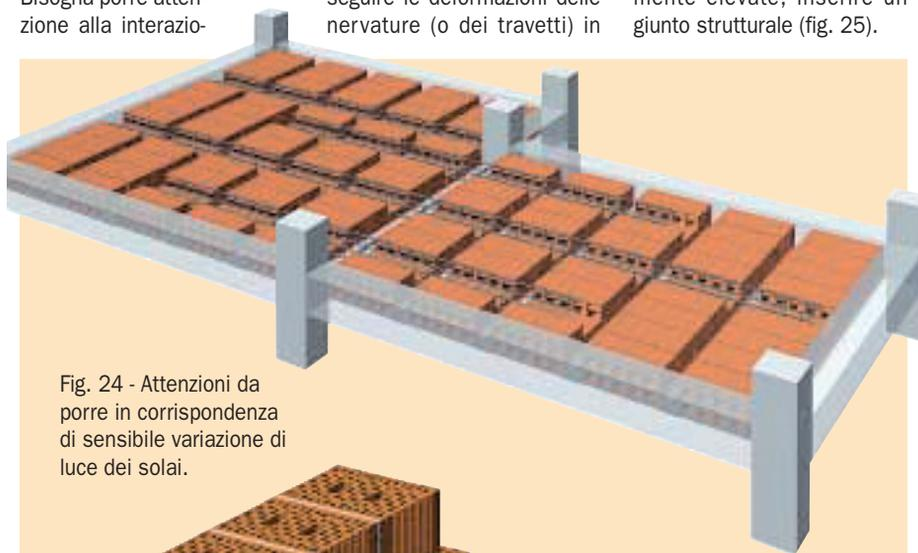
Fig. 24 - Attenzioni da porre in corrispondenza di sensibile variazione di luce dei solai.
