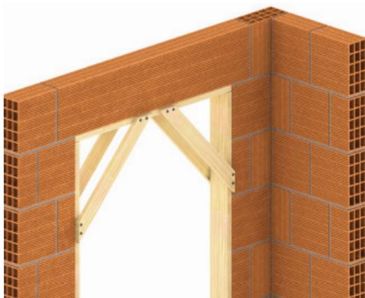
Figura 15 - Architrave in laterizio e posa in opera del telaio fisso di una porta interna.
