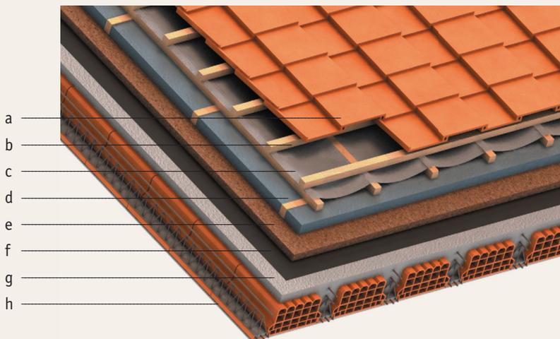
Legenda: *a* manto in laterizio, *b* intercapedine ventilata 6 - 8 cm, *c* membrana impermeabile traspirante "a corda blanda" Sd<sub>v</sub>, *d* isolante: polistirene espanso (EPS), *e* isolante: fibra di legno mineralizzata (FLM), *f* elemento di tenuta all'aria e/o all'acqua (eventuale), *g* solaio in latero-cemento 20 + 6 cm, *h* intonaco
