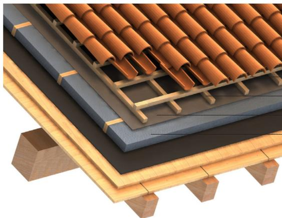
Figura 2 - Ventilazione sotto-manto mediante intercapedine unica.
