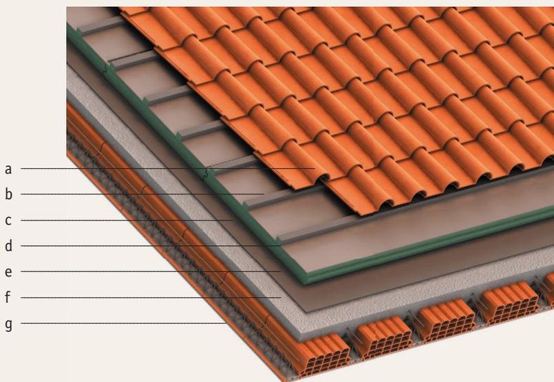
Legenda: *a* manto in laterizio, *b* listelli (lignei, metallici o incorporati con l'elemento di tenuta e l'isolante), *c* elemento di tenuta all'aria e/o all'acqua (eventuale) Sd<sub>v</sub>, *d* isolante: poliuretano (PIR), *e* barriera al vapore, *f* solaio in latero-cemento 16 + 6 cm, *g* intonaco
