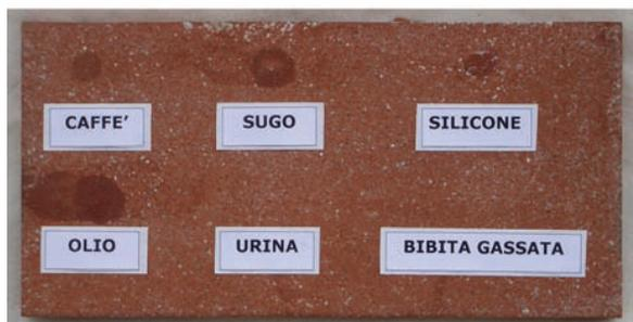
*Prova di macchiabilità su una pianella di cotto non trattata formata per estrusione. In alto, al momento dell'inizio della prova; in basso, dopo circa tre ore di permanenza dell'agente macchiante.*
